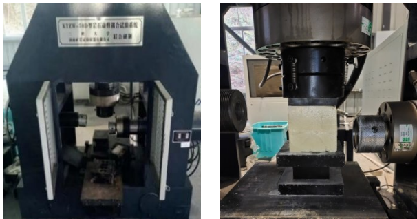
图 6 KYZW-50D 型岩石动剪耦合试验系统 Fig.6 KYZW-50D Rock Dynamic Shear Coupling System
